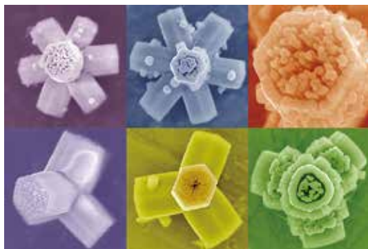
ZnS/SiO混合物を窒素雰囲気中で1300℃加熱して得られた6回対称7脚構造と3回対称4脚構造のZnS ナノフラワースのSEM像 SEM images of 6-fold symmetry heptapod- and 3-fold symmetry tetrapod-like ZnS nanostructures fabricated by thermal evaporation of a ZnS and SiO mixture source in N 2 at 1300℃
